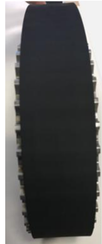
Po otočení řemen zůstal na řemenici
