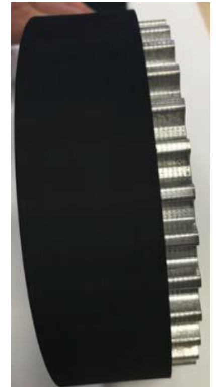
Řemen sjíždí z řemenice, je potřeba upravit ustavení
