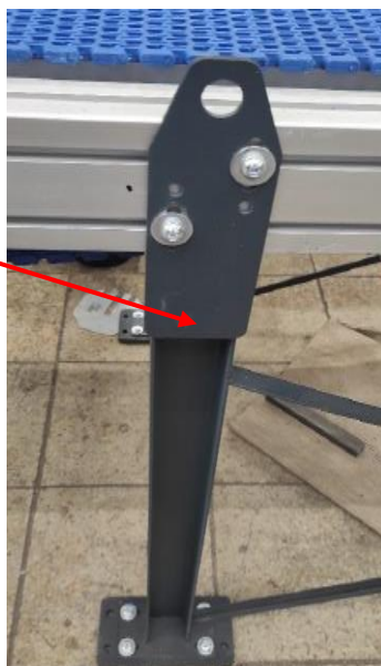
Obr. 15: Patky na ukotvení
